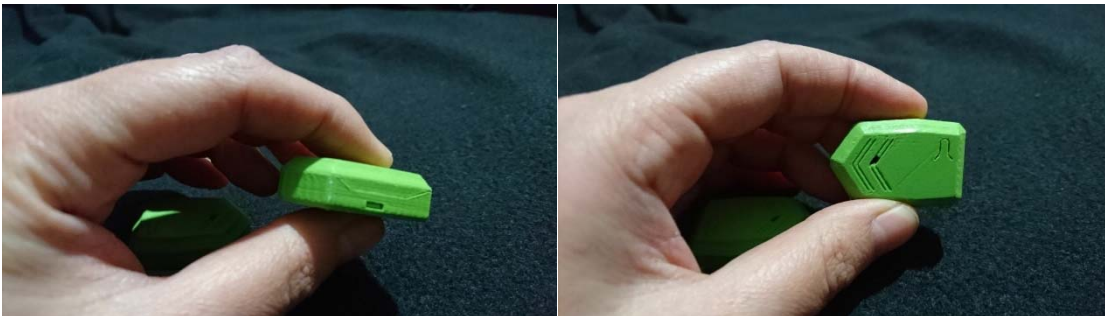
Abb. 39 – Entwicklung des 3D-gedruckten Modells für das IMU-Gehäuse
